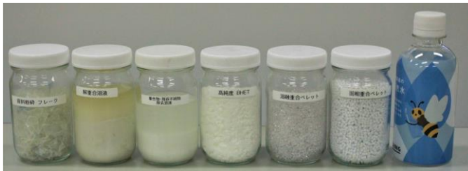
フレーク状の原料(左端)からPET樹脂を再生する過程 (右端が再生樹脂を用いたペットボトル)
